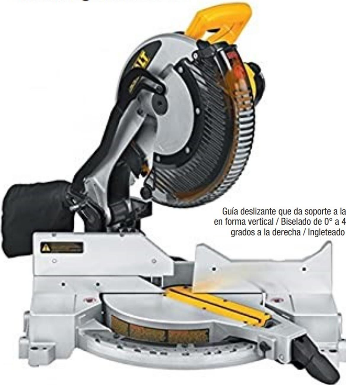
Guía deslizante que da soporte a las molduras de corona y de la base en forma vertical / Biselado de 0° a 48° grados a la izquierda y de 0° a 3° grados a la derecha / Ingleteado de 0° a 50° hacia ambos lados.
